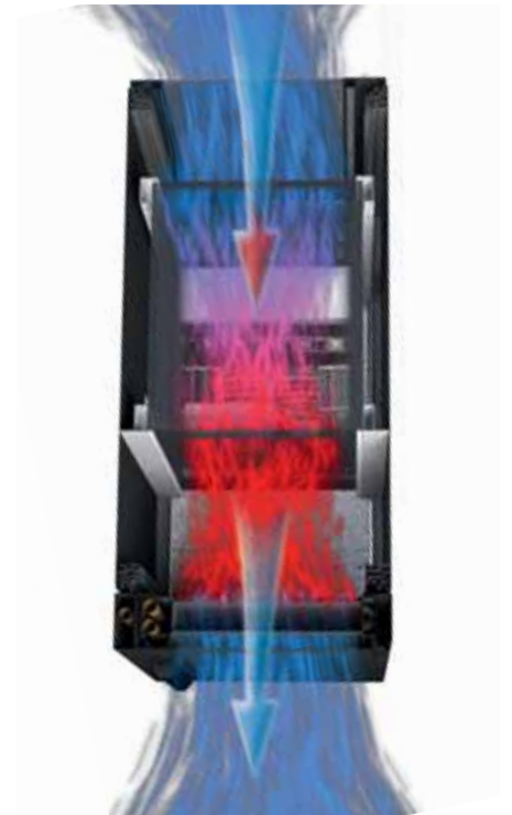
Luftstrom Serverrack m. Vertiv Knürr DCL (Schnittdarstellung)
