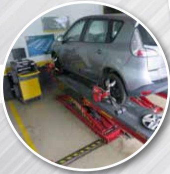
TEST IN NASTAVITEV GEOMETRIJE PODVOZJA - OPTIKA
