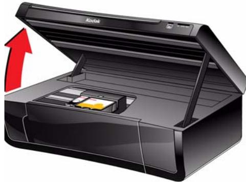
3. Entfernen Sie beide Tintenpatronen, und legen Sie sie beiseite.
