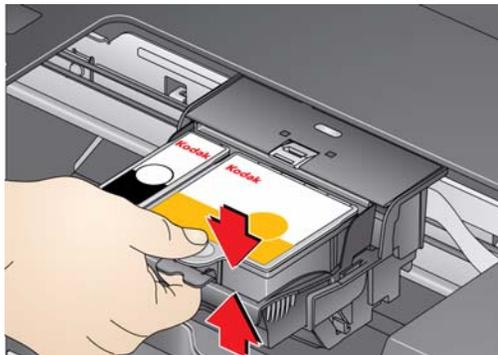
4. Entriegeln Sie den gebrauchten Druckkopf, indem Sie den Druckknopf in der Mitte des Druckschlittens anheben.
