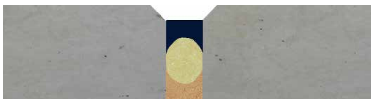
Aufbau einer Bewegungsfuge, abgedichtet mit Fugenspachtel
