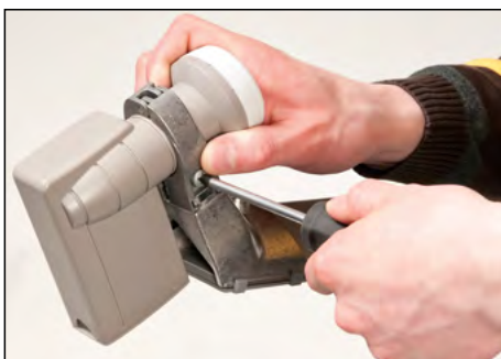
LNB-Halterung am Tragarm befestigen
