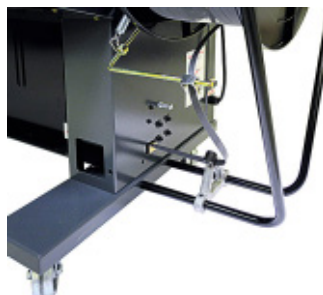
Unkompliziertes und automatisches Einfädeln des Umreifungsbandes
