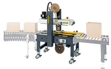
Rollenbahnen als starre und ausziehbare Version optional erhältlich
