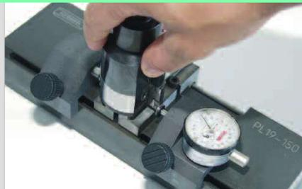
Werkzeug zwischen die Messflächen schieben und durch Drehung der Reibahle das Größtmaß ermitteln.
