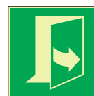
E057 Tür öffnet durch Ziehen auf der linken Seite ASR A2.3, DIN 67510, DIN EN ISO 7010
