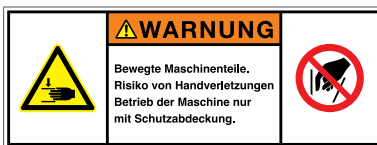
P015 Hineinfassen verboten, W024 Warnung vor Handverletzungen Warnung Bewegte Maschinenteile. Risiko von Handverletzungen Betrieb der Maschine nur mit Schutzkleidung.
