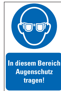
M004 Augenschutz benutzen In diesem Bereich Augenschutz tragen!
