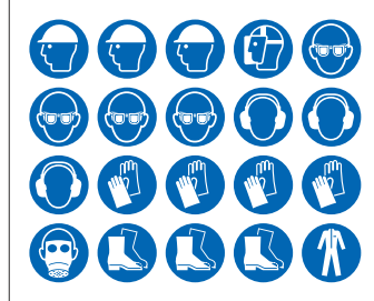
M003 Gehörschutz benutzen, M004 Augenschutz benutzen, M008 Fußschutz benutzen, M009 Handschutz benutzen, M010 Schutzkleidung benutzen, M013 Gesichtsschutz benutzen, M014 Kopfschutz benutzen, M017 Atemschutz benutzen
