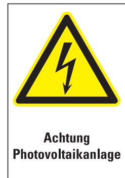
W012 Warnung vor elektrischer Spannung Achtung Photovoltaikanlage
