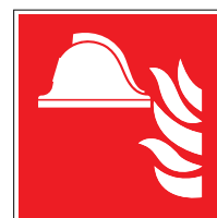
F004 Mittel und Geräte zur Brandbekämpfung
