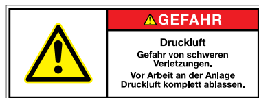
W001 Allgemeines Warnzeichen Gefahr Druckluft Gefahr von schweren Verletzungen. Vor Arbeit an der Anlage Druckluft komplett ablassen.
