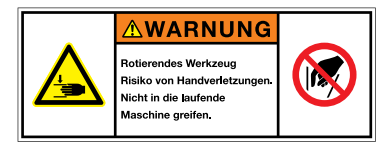
P015 Hineinfassen verboten, W024 Warnung vor Handverletzungen Warnung Rotierendes Werkzeug Risiko von Handverletzungen. Nicht in die laufende Maschine greifen.
