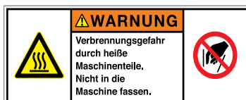
P015 Hineinfassen verboten, W017 Warnung vor heißer Oberfläche Warnung Verbrennungsgefahr durch heiße Maschinenteile. Nicht in die Maschine fassen.
