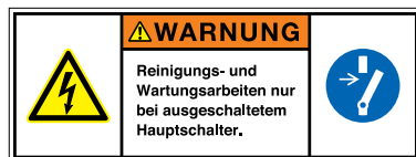
Warnung Reinigungs- und Wartungsarbeiten nur bei ausgeschaltetem Hauptschalter.
