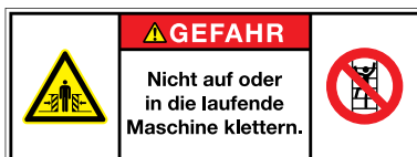
P009 Aufsteigen verboten, W019 Warnung vor Quetschgefahr Gefahr Nicht auf oder in die laufende Maschine klettern.
