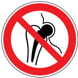
P014 Kein Zutritt für Personen mit Implantaten aus Metall ASR A1.3, DIN EN ISO 7010
