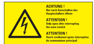
W012 Warnung vor elektrischer Spannung ACHTUNG! Nur nach Ausschalten des Hauptschalters öffnen ATTENTION! Only open after interrupting the main switch ATTENTION! Ouvrir seulement après interruption du commutateur principal
