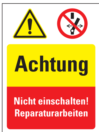
P031 Schalten verboten, W001 Allgemeines Warnzeichen Achtung Nicht einschalten! Reparaturarbeiten
