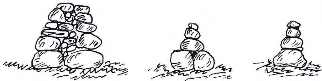
Figur 55. En dubbel stenmur längst till vänster i bild samt två varianter av enkel stenmur till höger. Efter ULMA 1850, Ugglums socken och Gudhems härad år 1928, bladet märkt: Tekningar till art. Hägnader. V, och figurerna 1-3 från vänster till höger.
