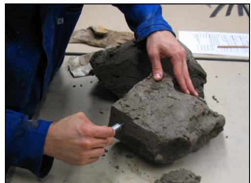
Bild 9: Bestimmung der undräniereten Scherfestigkeit mit dem Taschenpenetrometer
