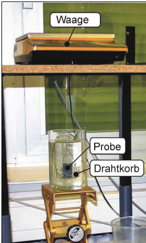
Bild 10: Bestimmung der Zerfallsziffer nach ENDELL
