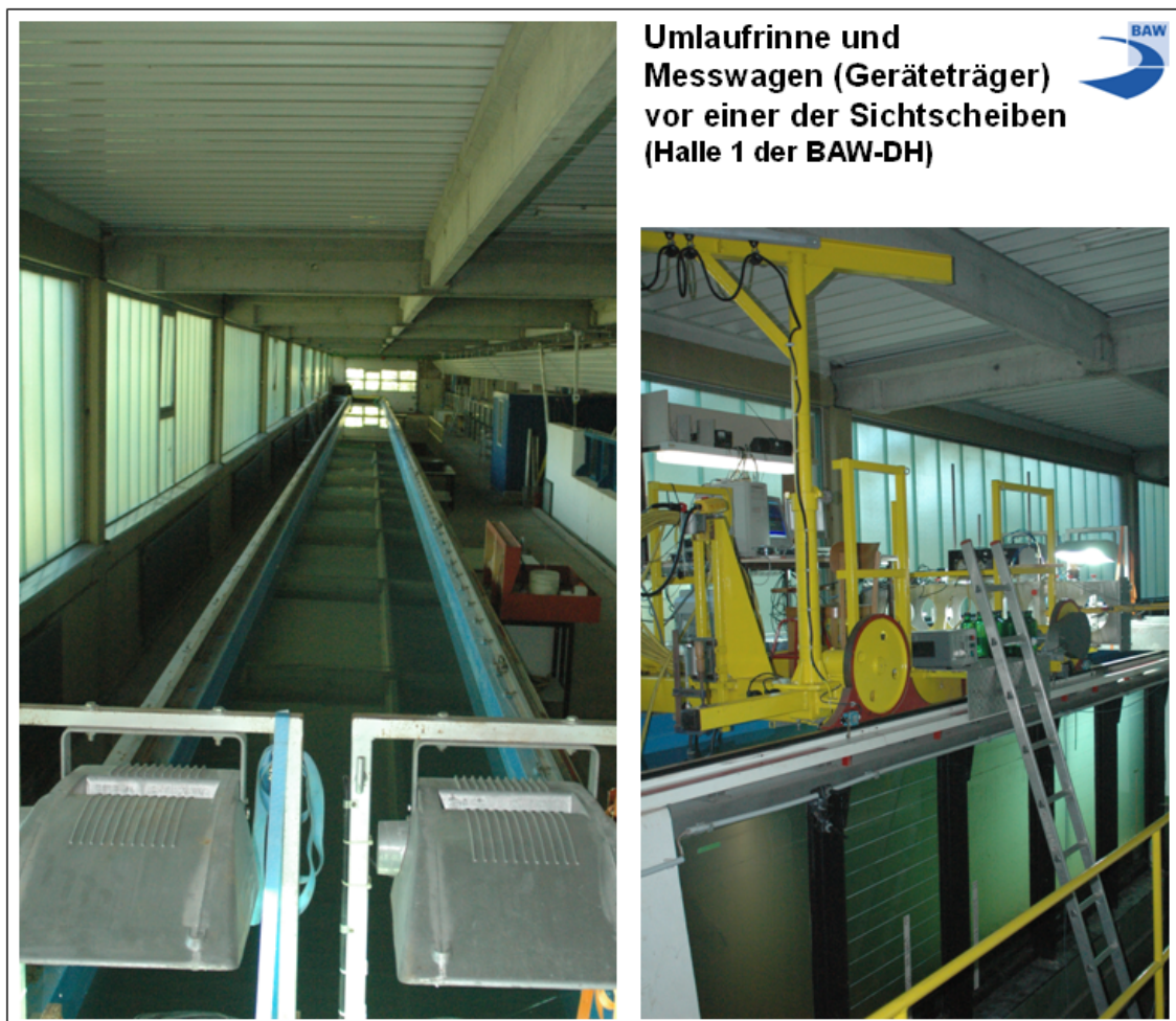
Bild 5: Blick auf die Untersuchungstrecke in der Umlaufrinne (links) sowie ausgerüsteter Messwagen vor einer der Sichtscheiben
