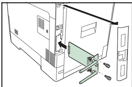
Die WLAN-Schnittstellenkarte unterstützt die Standards IEEE802.11n (Max. 300 Mbps) und 11 g/b.
