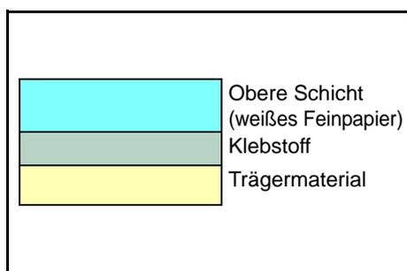
Etiketten bestehen aus drei Schichten (siehe Abbildung). Der Druck erfolgt auf der oberen Schicht. Die Kleberschicht enthält druckempfindliche Klebstoffe. Das Trägermaterial hält die Etiketten bis zur Verwendung zusammen. Auf Grund seiner Zusammensetzung ist Etikettenmaterial besonders anfällig für Druckprobleme.
