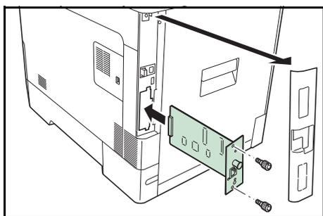
Das Netzwerkkit kommuniziert mit bis zu 1 GB pro Sekunde. Zusätzlich zu TCP/IP und NetBEUI wird auch IPX/SPX und Apple Talk von der Standard Schnittstelle unterstützt. Daher arbeitet der Drucker auch in Windows, Macintosh, UNIX und Netware Umgebungen. Für weitere Informationen siehe *IB-50 User's Manual*.
