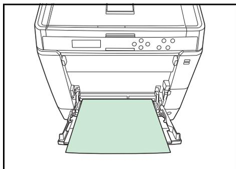
Um Druckprobleme zu vermeiden, ziehen Sie immer nur eine Folie über den *Universaleinzug* ein. Legen Sie die Folien immer vertikal ein, also mit der langen Seite parallel zum Drucker.
