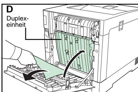
Hat das gestaute Papier die Duplexeinheit erreicht, wie in der Abbildung D gezeigt, heben Sie die Duplexeinheit an und entfernen Sie das Papier.
