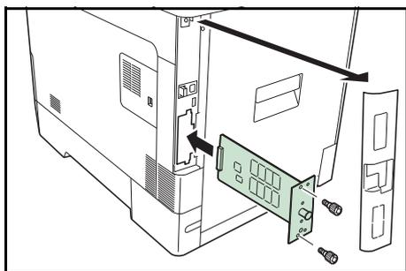
Setzen Sie die SSD in den optionalen Schnittstellen-Einschub. Ist eine SSD im Drucker installiert, können die eingehenden Druckdaten in Rasterdaten umgewandelt und auf dieser SSD gespeichert werden. Anhand dieser gespeicherten Daten können mit Hilfe einer elektronischen Sortierfunktion Mehrfachkopien eines Druckauftrags mit hoher Geschwindigkeit ausgegeben werden. Außerdem kann die Auftragsbox verwendet werden. Details finden Sie unter *Auftragsbox auf Seite 4-24*.
