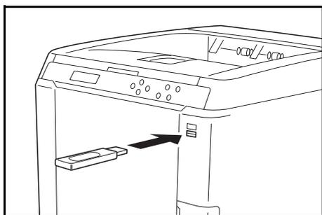
Der USB-Speicher erlaubt die Verarbeitung von externen Daten, wenn er in den Drucker gesteckt wird. Auf dem USB-Speicher gespeicherte Dateien können per Dateiname über das Bedienfeld ausgewählt und gedruckt werden.
