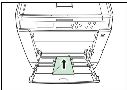
Umschläge müssen immer über die Universalzufuhr eingezogen werden, wobei die zu bedruckende Seite unten liegt. Umschläge müssen über die Universalzufuhr oder die optionale Papierzufuhr PF-530 eingezogen werden.
