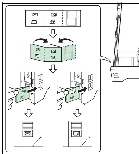
Wollen Sie die optionale Papierzufuhr PF-530 mit nicht Standard-Papier befüllen, falten Sie die Medientyp-Markierung bis Sie das gewünschte Symbol nach außen und oben gerichtet sehen und schieben Sie diese in die Markierung der Papierzuführung, so dass der verwendete Medientyp angezeigt wird.
