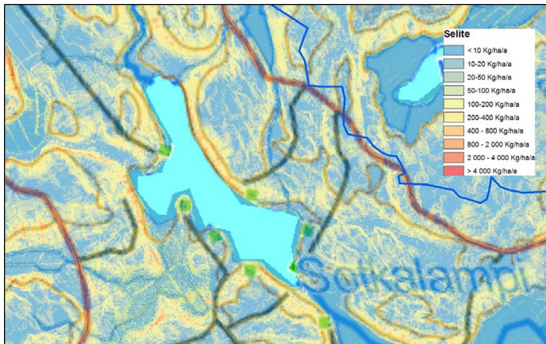
Kuva 12. RUSLE-eroosiomallin perusteella voidaan arvioida eri pisteiltä toimenpiteen jälkeen huuhtoutuvan kiintoaineksen määrää (kg/ha/a) ja sen perustella esim. leveämmän suojaväyhykkeen tarvetta.
