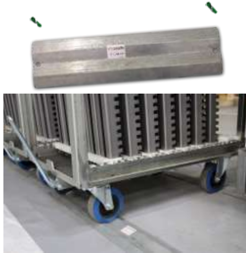
Der Positionierer blockiert die beiden Vorderräder
