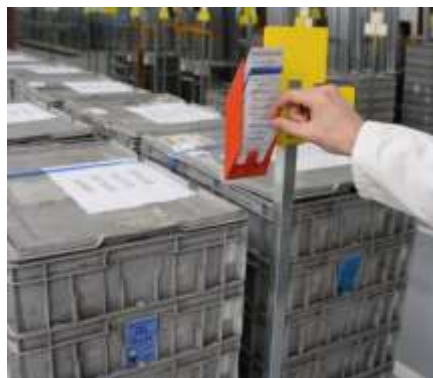
Kanban-Karten-Halter auf einem Pfosten des Lager-Moduls
