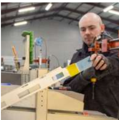
Durch die Rücklauf-Rinne wird die Kanban-Karte wieder auf die Anlieferseite des Rollis-Zuges gebracht
