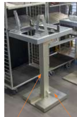
Der Ständer (L0547) mit Ballast (L0288) enthält Montageschablonen und Werkzeuge
