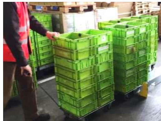
Die Rollis® werden mit dem Zughaken herausgefahren (L0005)
