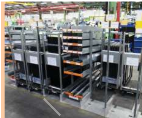
Gemischter Rand einer Montageanlage: Behälter in dynamischen Rack und Rollis
