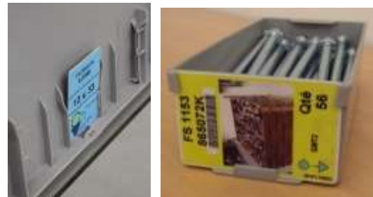
Die Kanban-Karte befindet sich in Kerben, die in der Masse eingeformt sind; lässt sich durch die leicht schräge Position leicht greifen
