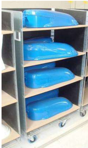
Rollis 400 x 800 mit Akilux Schutz.
