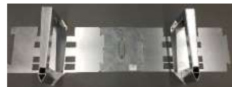
Schablonen zum Positionieren der Bodenplatten in 600 mm breiten Reihen
