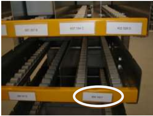
Etikettenhalter zur Identifizierung jedes Ganges
