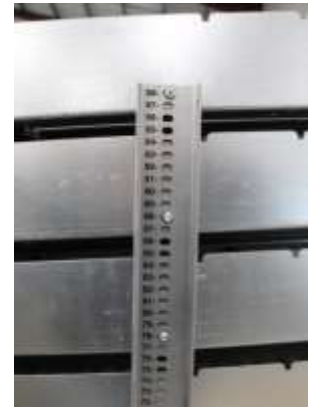
Die Ebenen sind durch die Einteilung der Graduierungen an den Ständern in der Höhe leicht verstellbar
