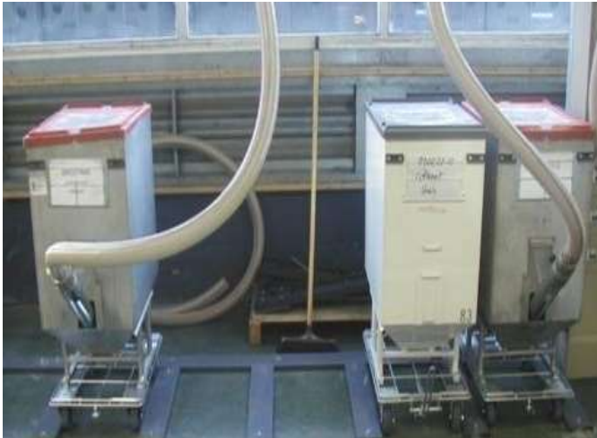
Die geringe Größe des Rollis ermöglicht es, mehrere Farbtöne so nah wie möglich an die Spritzgießmaschine heranzuführen.
