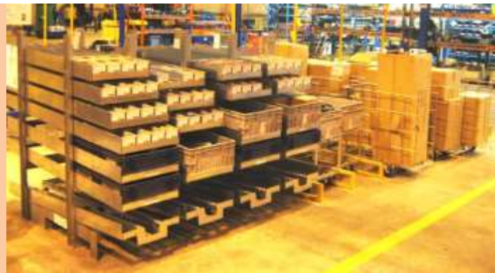
Jedes Rack-Regal richtet sich nach dem Behältertyp. Der Zugriff auf die Teile ist konzentriert und reduziert die Bewegung des Mitarbeiters.
