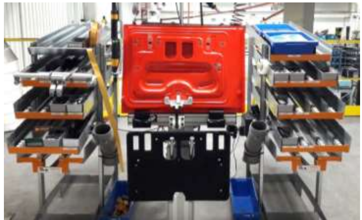
28 Teile werden in den Greifbereich des Mitarbeiters gebracht
