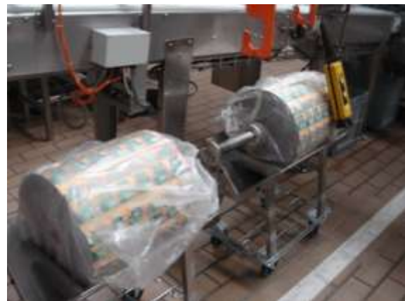
Einsetzen der Stützachse in Stehhöhe
