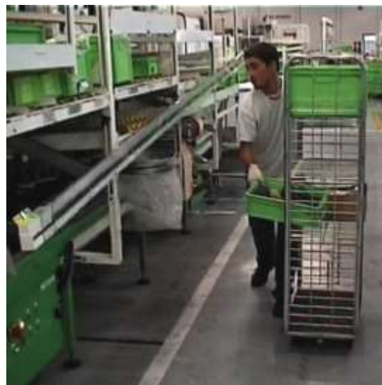
Anlieferung mit einem einzigen Wagen der vom Zug abgekuppelt wird
