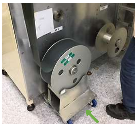
Seitliches Laden einer Spule auf eine Spindel
