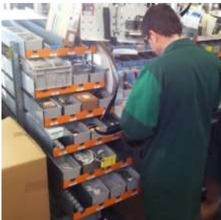
Ergonomisches Greifen der Teile durch die Versetzung der Ebenen
