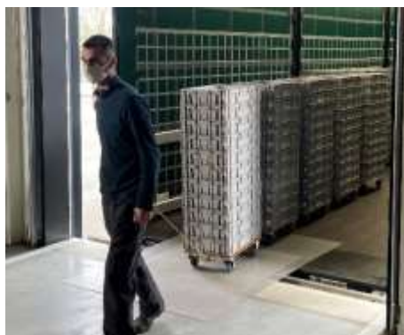
Eine Polycarbonat Platte zwischen der Rampe und den Anhänger ermöglicht das Ein-und-Entladen von Rollis®
