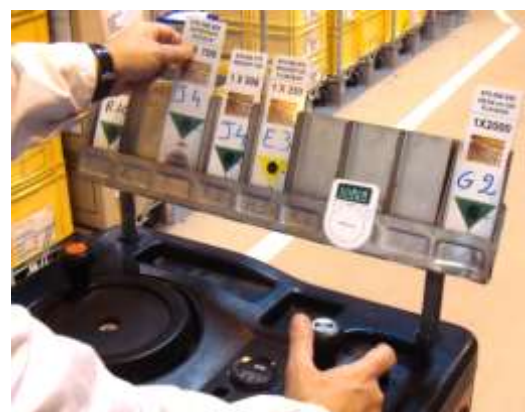
Option: Schaltuhr (L0342) zur Taktung der Arbeit des Lieferanten. Achtung, die Taktung erfolgt über die Arbeitsorganisation und nicht durch die Schaltuhr.
