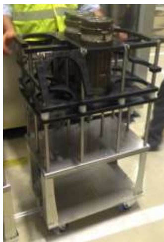
Rollis zum schnellen Wechseln von Spritzgießwerkzeugen
