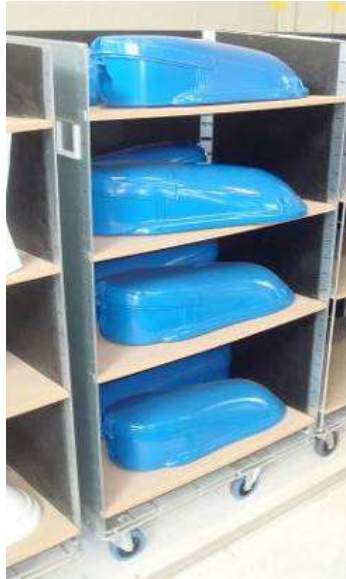
Rollis 400 x 800 mit Akilux Schutz.
