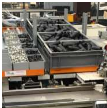
Belieferung am Arbeitsposten mit Mini-Behälter und Behälter
