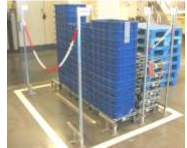
Lagermodul aus Edelstahl (L0084) zoniert mit Klebebändern und Kunststoffketten
