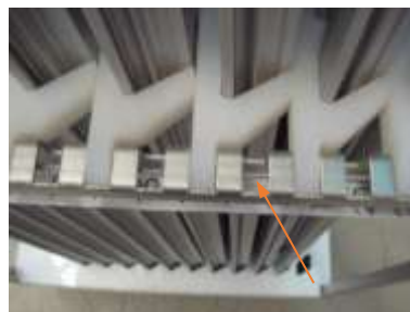
Edelstahl-Achse ( L0069 ), die in die Zahnstange eingesetzt ist und die Trennhalter durchquert.
