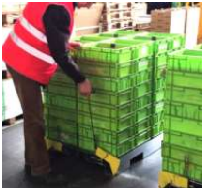
Die Sperrklinken werden geöffnet ohne sich zu bücken
