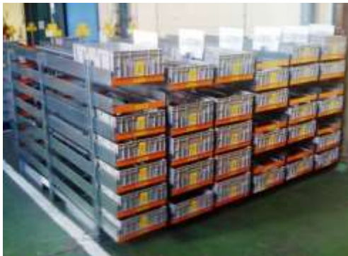
Die ergonomische Höhe von weniger als 1 350 mm, ermöglicht einen Überblick über die ganze Lagerhalle.
