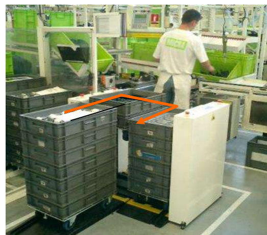
Die Stapelhebemaschine reduziert die Versorgungsfläche und macht den Arbeitsraum heller
