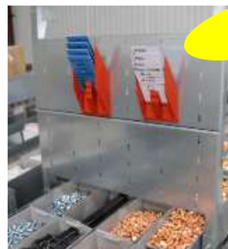
Ständer für Kanban-Karten-Halter auf einem Rack (L0542)
