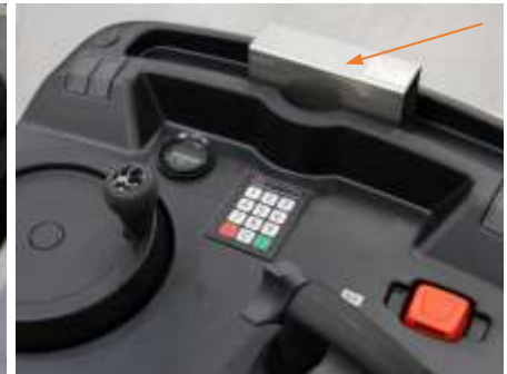
Blockierer auf die Bedienungsstafel der Ergomover-Lokomotive gestellt
