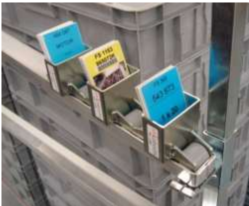
Die Karten gelangen in den Roll-Becher gegenüber dem Mitarbeiter in der Reihenfolge der Produktion. Die verschiedenen Karten stellen die zu erstellenden Referenzen dar.
