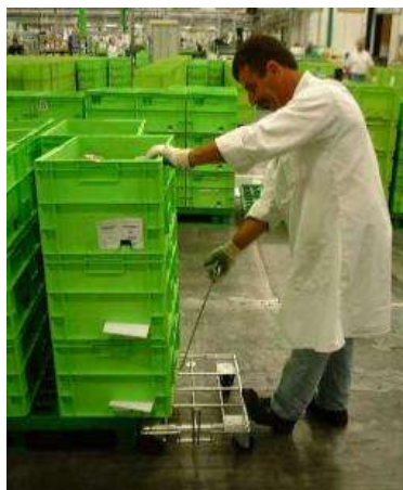
Manuelle Übertragung der Palette auf Rollis®
