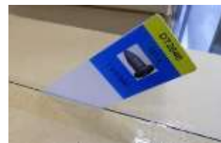
Die Karte kann direkt in die Rillen des Kartons eingefügt werden, um den Kartoninhalt zu identifizieren. Die Information auf der Kanban-Karte ist immer sichtbar.
