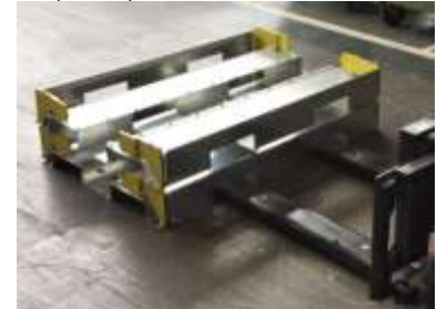
Aufgenommen auf beiden Seiten mit dem Gabelstapler
