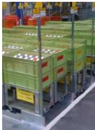
Beschwerte und erhöhte Rollis für Schalterpole aus Kupfer L0111
