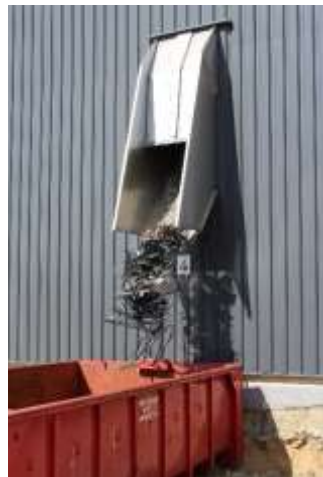
Der Vidatris überquert die Wand und ermöglicht das Leeren des Müllbehälters ohne Verlassen des Gebäudes
