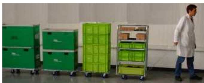
Zug mit Rollis® und Servierwagen um eine Produktionslinie zu beliefern
