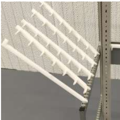
Befestigung der Trennhalter an der linken Zahnstange.
