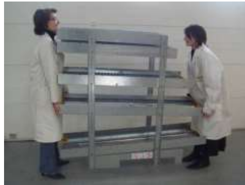
Die selbsttragende Struktur ermöglicht die Bewegung des Racks mit der Hand an den Verbrauchsort auf der Linie
