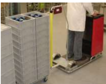
Der Blockierer hält 2 Stapel von Behältern 400 x 300 auf einem Rollis
