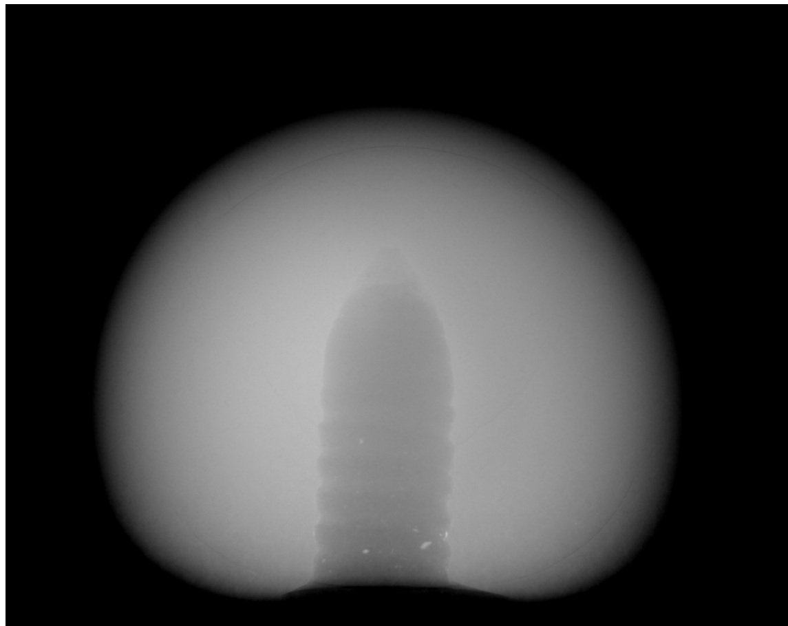
Trou de perçage trop gros
