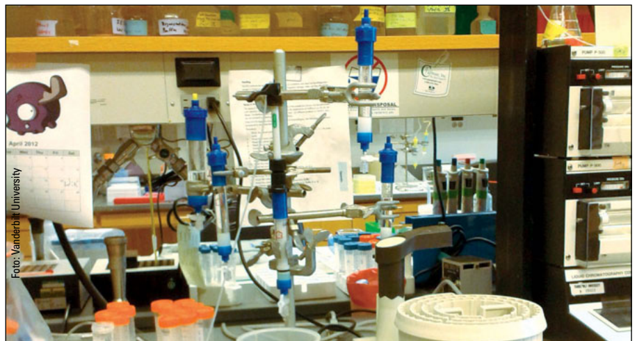
Alles bereit zur Proteinreinigung mit einer Nickel-NTA-Affinitätsäule.
