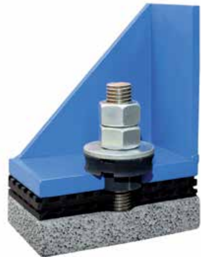
Quellenisolierung am Beispiel einer Maschinenanbindung
