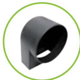
Bűzzár bekötő aknához 100/150-es méretben utólagos beszereléshez Beépítés: A bűzzár a bekötőakna belsejébe kell helyezni majd a PVC csővel összekötni
