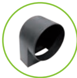
Búzzár bekötő aknához csőcsatlakozással DN 100 és 150 Beépítés: Helyezze a búzzárt a bekötő akna belsejébe és a csőcsatlakozóval kívülről illesse össze.
