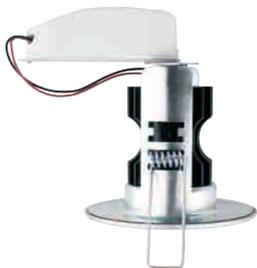
Material: Aluminium; komplette LED-Einheit zum Direktanschluss an 230V; alternative zu 50W Halogen, nur 9W Power-LED, Ausstrahlwinkel 50°; bis zu 82% Energieersparnis. F90 feuerbeständig; IP44; 7-Jahre-Gewährleistung; D: 91mm; DA: 60mm; ET: 109mm
