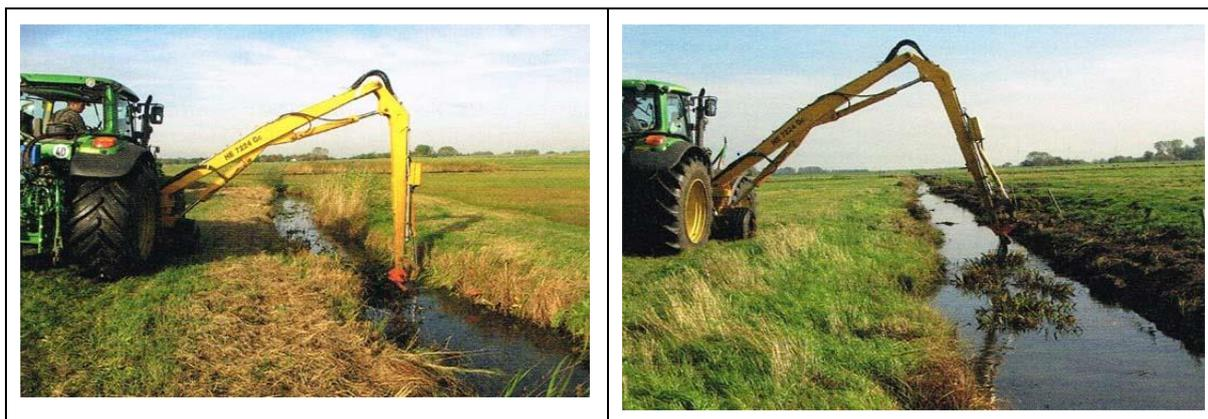
Abb. 3-6, 3-7: Entnahme und Bepflanzung von *Stratiotes aloides* mit einem „*Stratiotes*-Pflücker“ (KASTNER et al. 2016)
