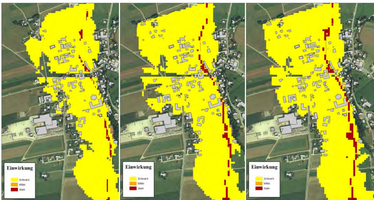
Abbildung 3.9 Ausweisung der Einwirkungsintensität nach BUWAL HQ 30 , HQ 100 und HQ 300 (von links nach rechts)
