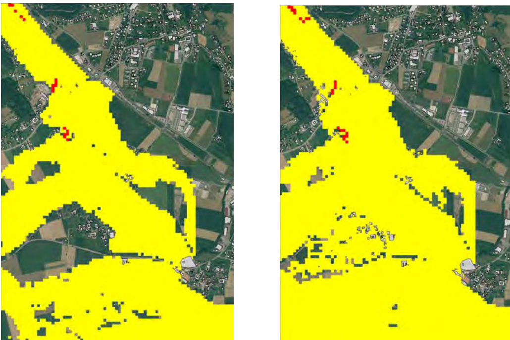
Abbildung 3.19 Visualisierung der Einwirkungsintensität nach dem Produkt aus Fließgeschwindigkeit und Überflutungstiefe nach WLW HQ 300 und HQ 5000
