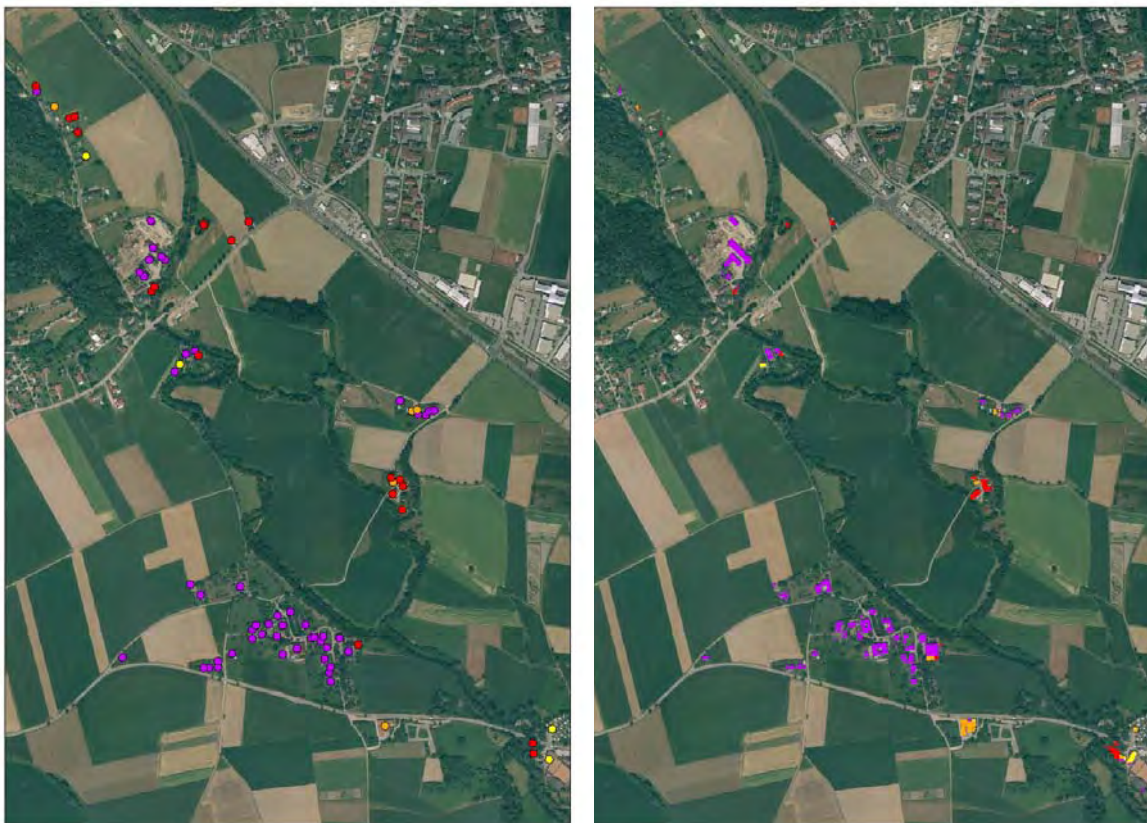
Abbildung 3.21 Betroffene Gebäude bzw. Gebäudeflächen HQ_{30} , HQ_{100} , HQ_{300} HQ_{\text{extrem}} (gelb, orange, rot, violette)
