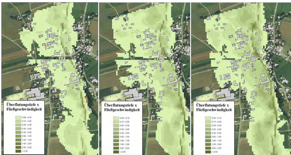
Abbildung 3.5 Visualisierung des Produkts aus Überflutungstiefen und Fließgeschwindigkeiten HQ 30 , HQ 100 und HQ 300 (von links nach rechts)
