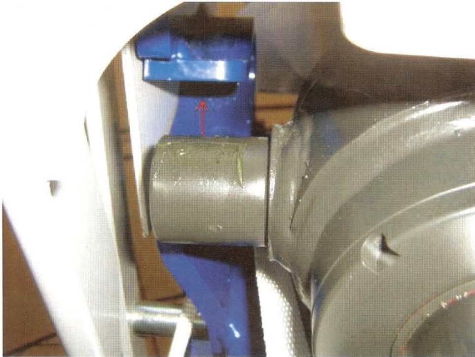
Bild 5. Den Zylinder soweit auseinanderfahren bis die Zentrierbolzen des Zylinders in die Haltetaschen des Spalters positioniert sind. (Den Zylinder mit der freien rechten Hand vorsichtig beim auffahren richten damit der Zylinder in die Haltetaschen einfahren kann und nicht das Schutzblech beschädigt)
