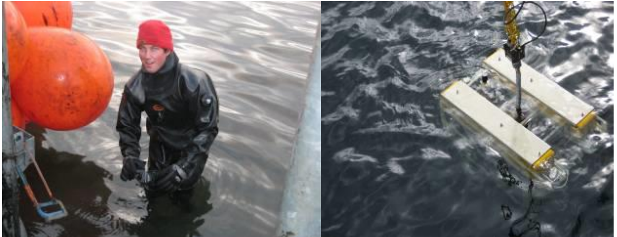
t.v. "dykare" kapar kabeln i mycket grunt vatten. T.h. sjösättning av ROV
