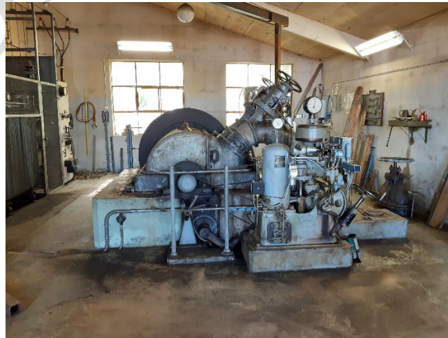
Figur 10. Till vänster. Flodutskov vid Häldelholms kraftverksdamm, sedd från nedströms-sidan. Foto: Länsstyrelsen 2021-05-28. Figur 11. Till höger. Häldelholms Peltonturbin inne i kraftstationen. Foto: Länsstyrelsen 2021-05-28.
