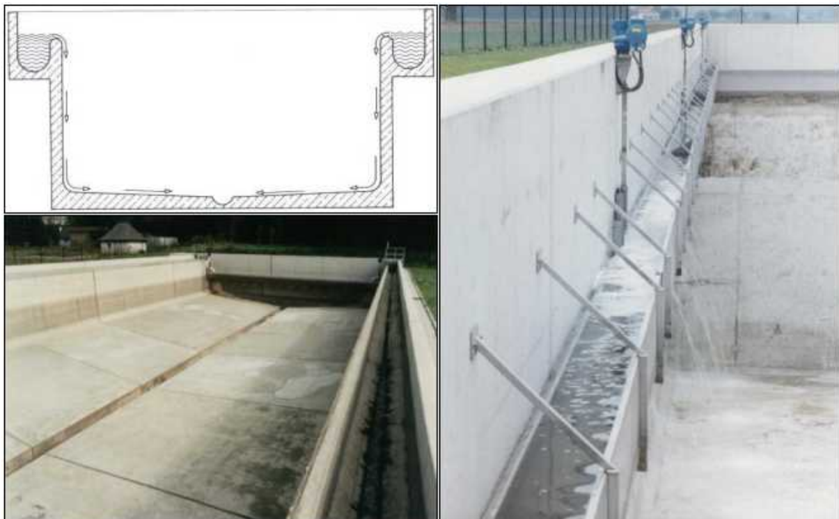
Bild 4.17: Schematische Darstellung einer Spülrinne (FAHRNER, 1999) und Spülrinnen in Regenbecken (WILLEMS, 2002)
