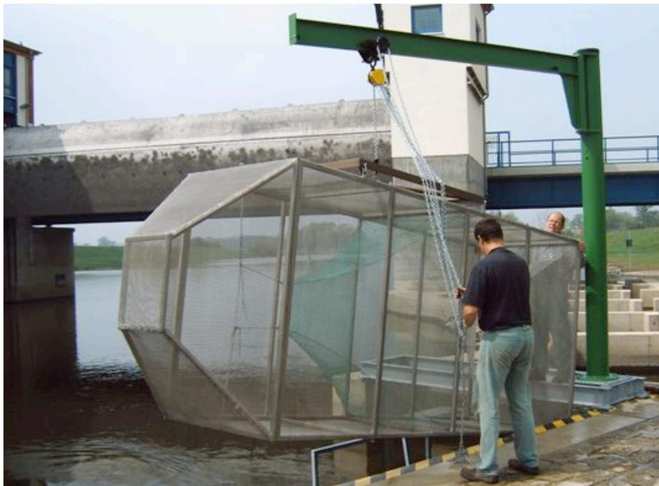
Abb. 2: Spezialreuse für das Steigalmonitoring am Wehr Gnevsdorf
