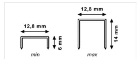
**Schmal Rücken-Heftklammern für Klammergerät Profifix 347/25**
