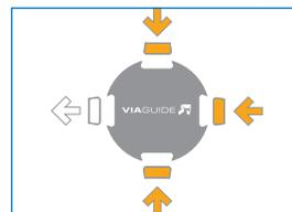
Jeder Pfosten mit 4 Längsnuten: Davon 3 für die Gurtaufnahme ankommender Gurte.
