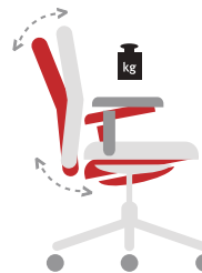
Synchronmechanik Die Rückenlehne neigt sich nach hinten und die Sitzfläche folgt in einem Verhältnis von 2:1. Der Gegendruck lässt sich individuell einstellen
