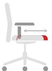
Sitztiefeverstellung Die Sitztiefe lässt sich, passend zur Länge der Oberschenkel, einstellen, indem der Sitz nach vorne oder hinten verschoben werden kann.
