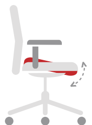
Sitzneigeverstellung Durch das Absenken der Sitzfläche wird der Druck auf die Oberschenkelunterseite verringert und der Oberkörper richtet sich auf und der Nutzer sitzt gerader
