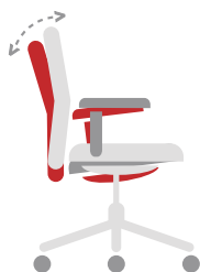
Wippmechanik Sitz und Rückenlehne bleiben, bei der Neigung der Rückenlehne nach hinten, in einem gleichen Winkelverhältnis. Der Gegendruck lässt sich individuell einstellen
