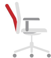
Permanentkontaktmechanik Die Rückenlehne folgt der Bewegung des Sitzenden bei einem starren Sitz, arretierbar
