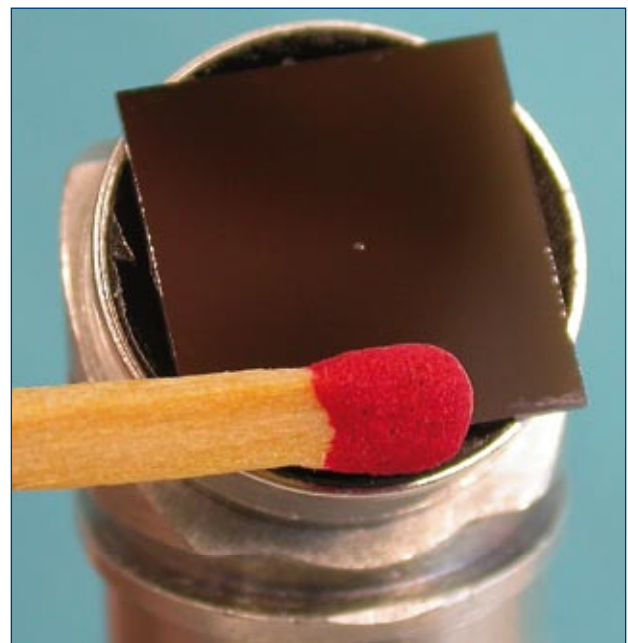
Abb. 2: Größenvergleich des Gästebuchs (weißer Fleck in der Mitte des quadratischen Silicium-Chips) mit einem Streichholz.
