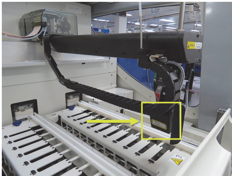
Figur 7: Billede af hovedrobotten med ID-imageren angivet med en pil
