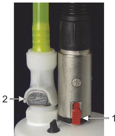
Figur 126: Tilslutninger til ekstern affaldsbeholder på nyere instrumenter: Væskeforbindelsesstik til venstre og forbindelsesstik til væskeniiveausensor til højre
