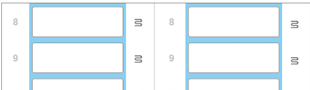
Figur 9: Grå symboler ved varmelegemet på hver plads betyder, at der er initieret en fuld nedlukning af varmelegemerne
