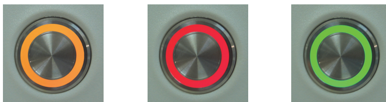
Figur 13: Objektglasbakkens LED-farver (orange, rød, grøn) på BOND-MAX-instrumentet
