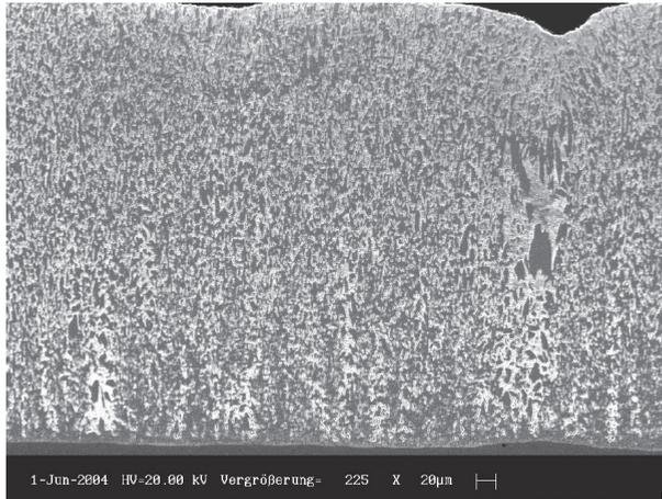
Abb. 34b: Zinkschichtaufbau auf Sandelin-Stahl; Verzinkungsparameter: 460 °C, 10 Minuten; REM-Aufnahme
