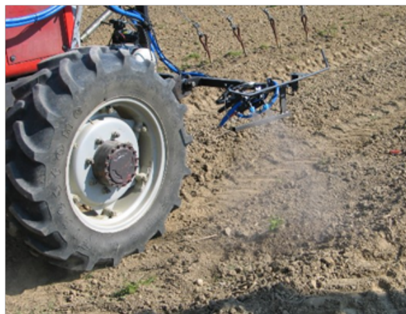
Abb.: Sensorgesteuerte Flachstrahldüsen zur Reihenbehandlung
