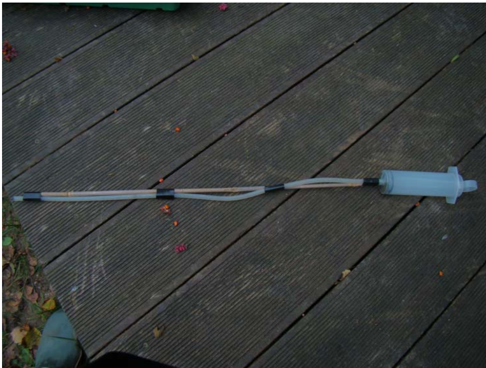
Abbildung 7: Beprobungswerkzeug für den Aufwuchs auf Sand, feinem Kies, auch zur Beprobung innerhalb eines Stechrohres. Spitze der Spritze (oder des Schlauches) knapp über das Sediment halten und ansaugen. Bei grobem Sand muss evtl. die Öffnung vergrößert werden
