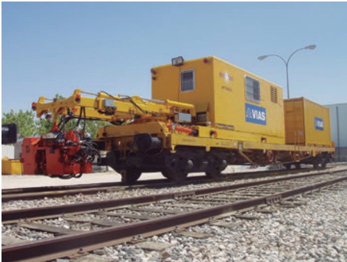
Imagen 2.27. Tren Soldadura Carril. Fuente: VIAS
