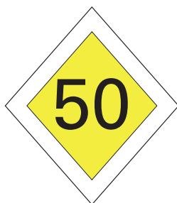
Figura 5. Señal ejecutiva de velocidad limitada. Fuente: RENFE
