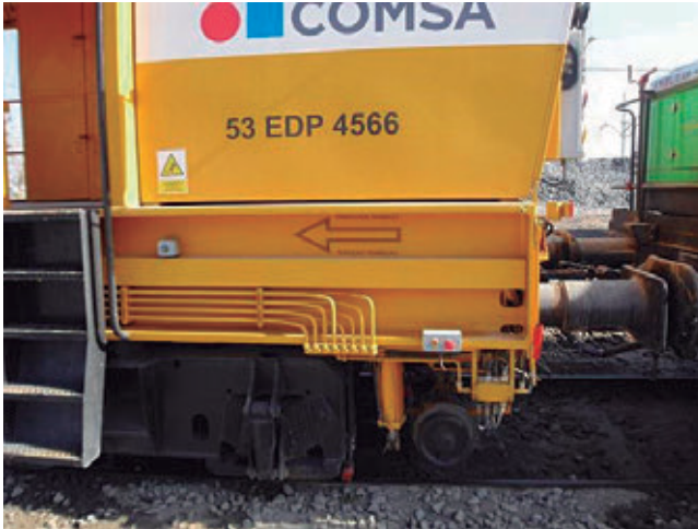
Imagen 3.16. Maquinaria con pulsador exterior de parada de emergencia. Fuente: COMSA
