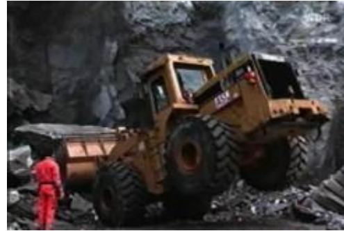
Imagen 24: Levantamiento de la pala por trabajar con el cucharón recogido, con riesgo de reventón de ruedas.
