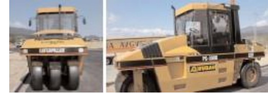
Imagen 45. Compactador de neumáticos.
