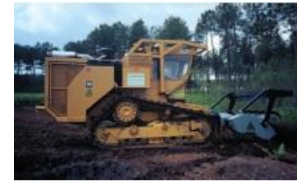
Imagen 12. Tractor de cadenas con trituradora de martillos, perfectamente protegido
