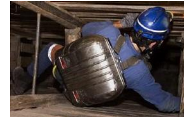
Imagen 17. Equipo de rescate de aire químico
