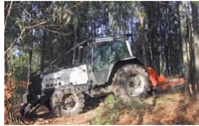
Imagen 11. Tractor de neumáticos con desbrozadora de cadenas. Fuente: Xunta de
