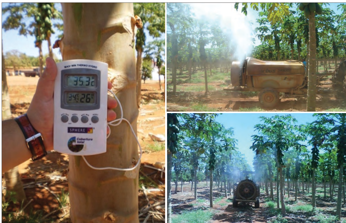
Figura 4 - Pulverização na cultura do mamão com equipamento de jato transportado em condições meteorológicas adversas - Mossoró, RN NOTA: Temperatura maior que 35 °C e umidade relativa (UR) do ar de 26%.
