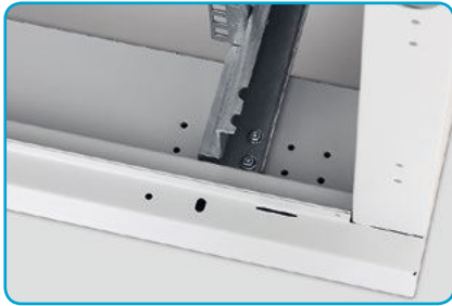
■ Flex frame Die Vierpunkthalterung ermöglicht bei 800 mm breiten Verteilern die Installation von verstellbaren Leisten im Abstand von 19", 21" und 23".
