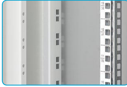
■ Perforierte Stützen Die Öffnungen über die gesamte Höhe der Stützen entsprechen den HE-Abständen der Vertikalen.
