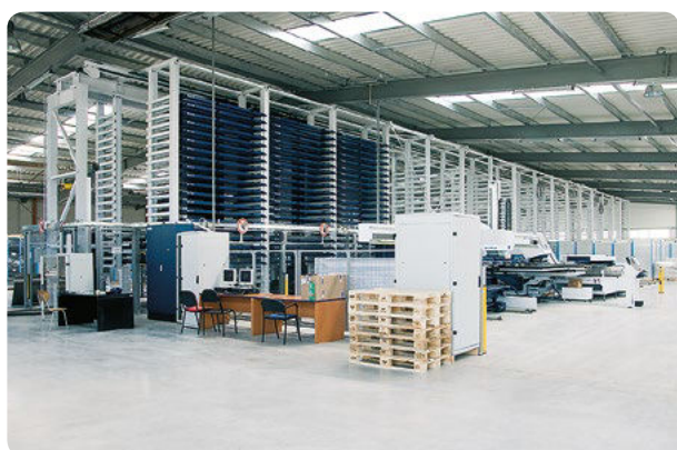
Automatisches Blech- und Halbfabrikatlager
