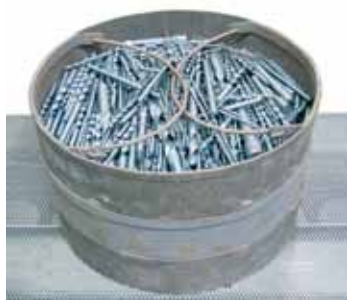
Azulamento de brocas com vapor de água num forno da série NRA
