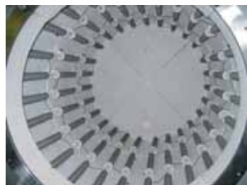
Aquecimento de fora à volta da retorta, modelos NRA ../09 e NR ../11
