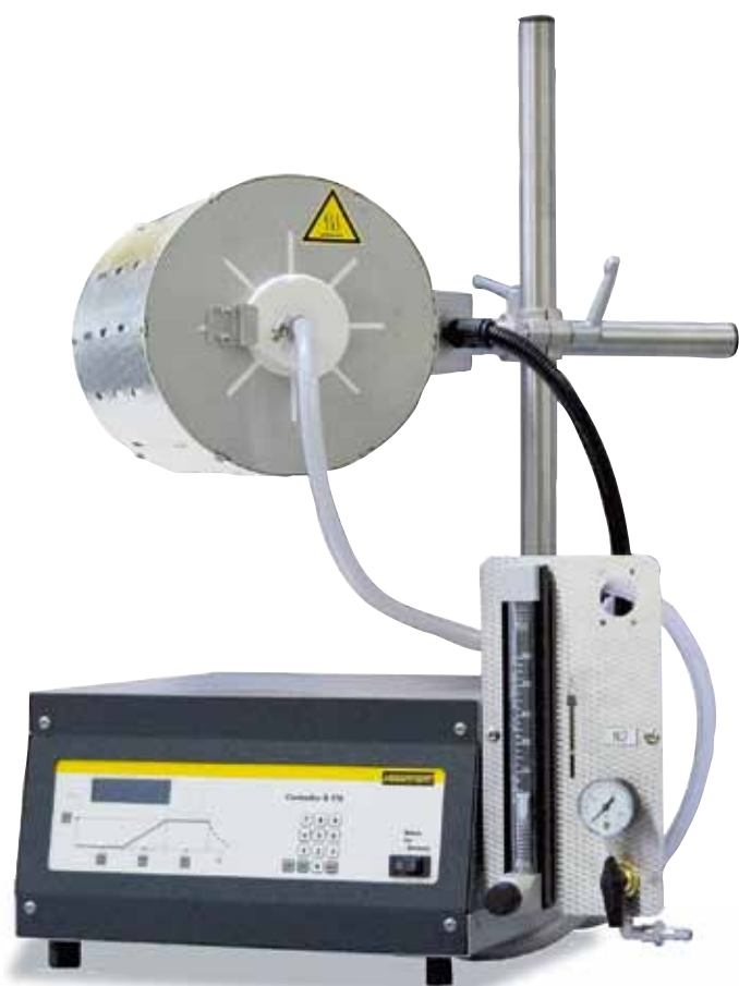
RT 50-250/11 com sistema de injeção de gás para nitrogénio
