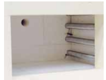
Câmara interior do forno com isolamento de tijolo refractário leve de elevada qualidade
