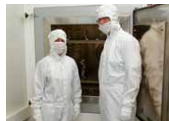
Forno de ar circulante N 250/65 HAC com câmara de forno em modelo isento de libertação de partículas. A porta do forno encontra-se para carregamento na sala limpa, classe 100, a câmara do forno, na câmara cinza atrás.
