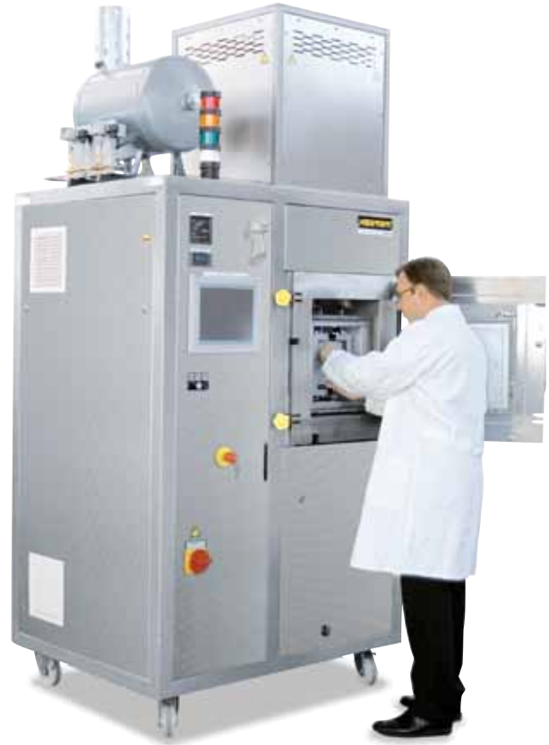
VHT 08/16 MO com kit de ampliação hidrogénio como versão automática
