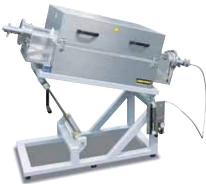
RSR-U 120/500/11 com reator fechado de um lado para a operação por lotes
