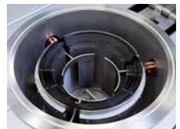
Retorta cilíndrica com aquecimento em volfrâmio
