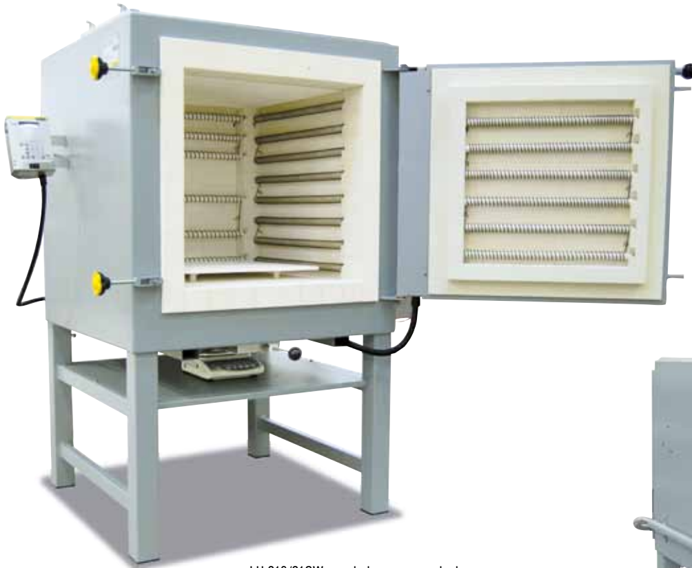
LH 216/21SW com balança para calcular a perda por calcinação
