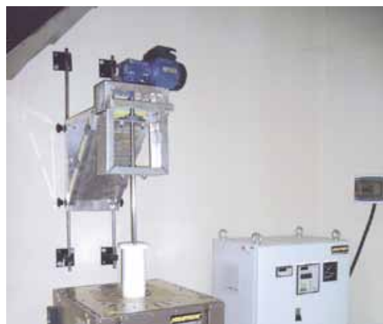
RHTV 120/300/15 integrado em um dispositivo de ensaio de tração
