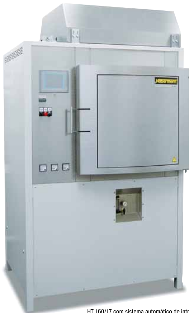
HT 160/17 com sistema automático de introdução de gás
