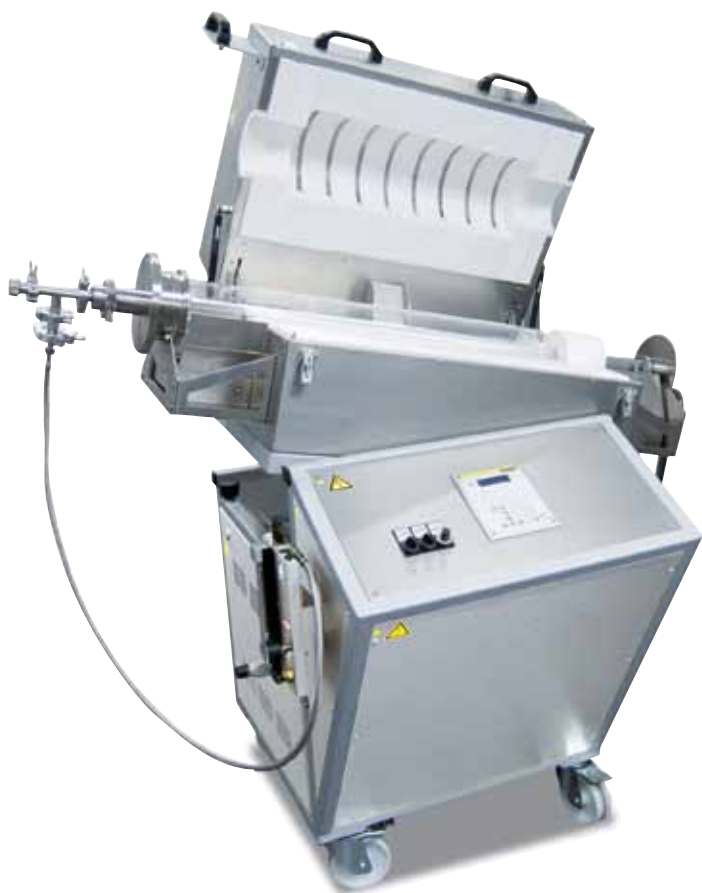
RSR-U 120/500/11 para operação por lotes com mecanismo basculante para enchimento e esvaziamento mais fáceis do reator
