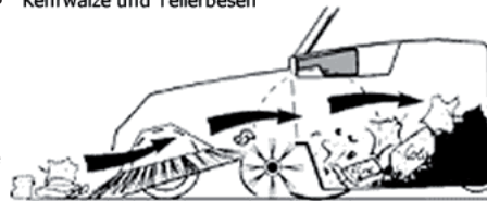
Turbosystem mit Kehrwalze und Tellerbesen
