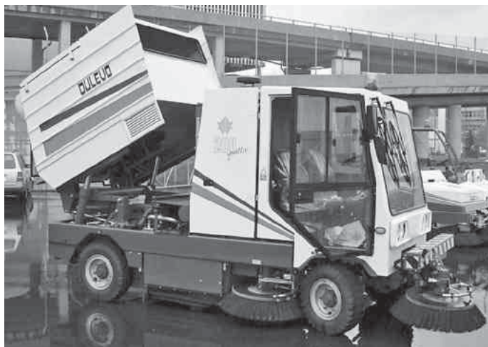
Schmutzbehälter wird zur Entleerung hochgefahren.
