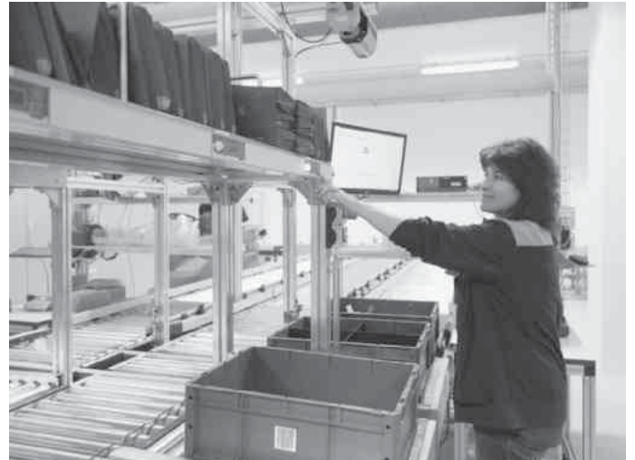
Multi-Order-Picking-Kommissionierplätze für Kleinteile und Paletten, unterstützt durch Pick-by-Light.
