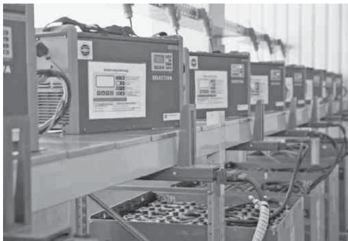
Zum Laden der Antriebsbatterien setzt Audi auf Fronius-Batterieladegeräte vom Typ Selectiva. Der Automobilhersteller war in den Entwicklungsprozess der Geräte von Anfang an involviert.
