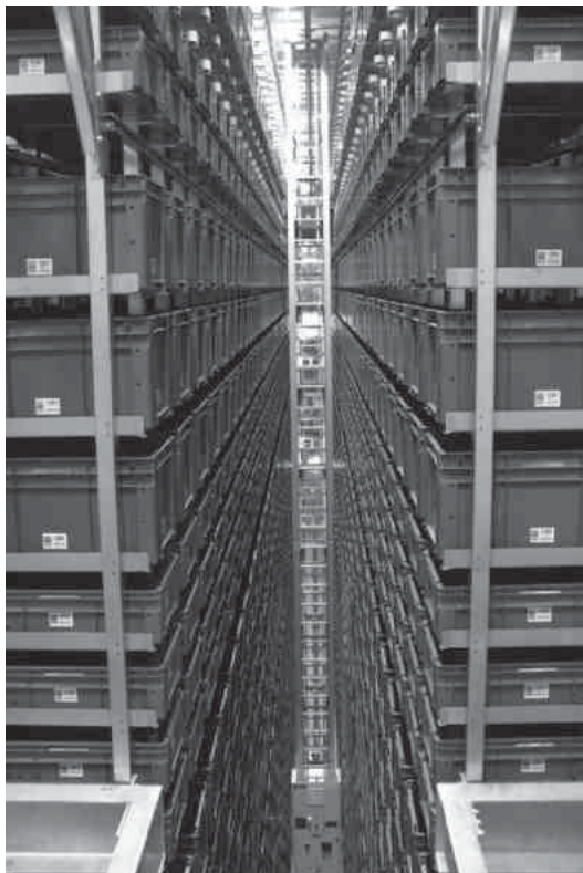
Abb. 2: Ein Blick in ein Hochregallager mit einem Kleinteilelager bei Hans Kohler AG. Quelle: agiplan
