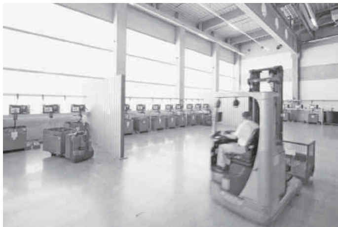
An mehreren Orten im Werk sind Batterieladeräume und -stationen platziert, an denen die Fahrer in nur wenigen Minuten die leere Antriebsbatterie gegen eine volle austauschen können.
