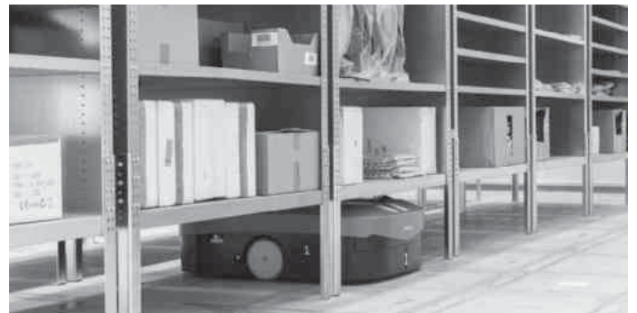
Die Ware-zur-Person Lager- und Kommissionierlösung Carry-Pick von Swisslog: Fahrzeuge heben ganze Regale an und bringen diese zur ergonomischen Kommissionierstation.
