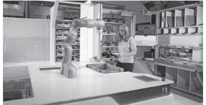
Der Mensch-Roboter-Arbeitsplatz «Automated Item Pick» von Swisslog mit dem ersten serientauglichen, kollaborativen Leichtbauroboter LBR iiwa von KUKA. Im Hintergrund das Carry-Pick-System mit den Regalen.
