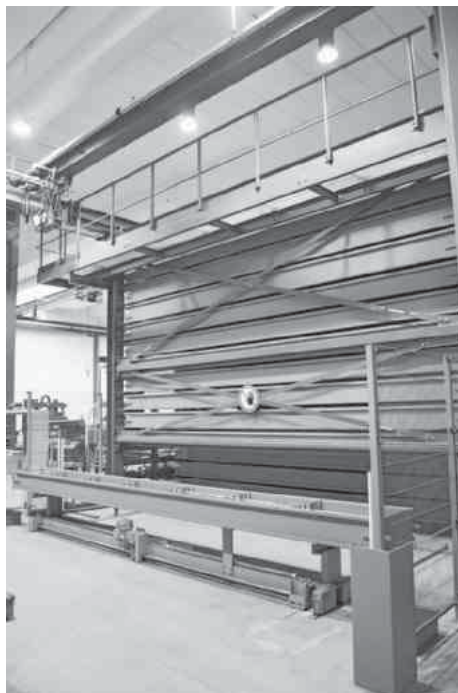
Das Lager verfügt über eine Ein- und zwei Auslagerstationen.
