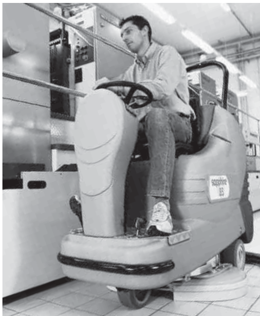
Adiatek-Sapphire 120 Liter Wasser und 88 cm Arbeitsbreite sorgen mitunter für eine grosse Flächenleistung.
