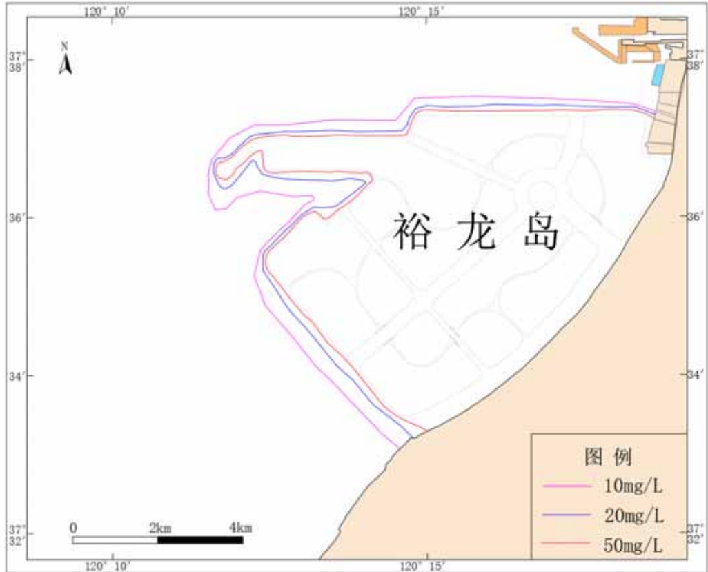
图 6.2-3 块石抛填悬浮泥沙扩散范围图
