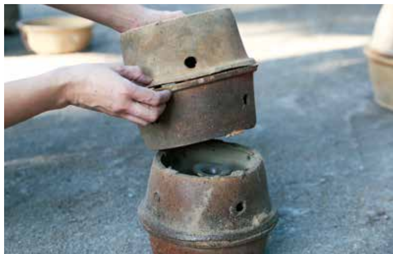
左 匣钵在燒窯時保護坯體，而且可以疊高，盡用窯內空間。
