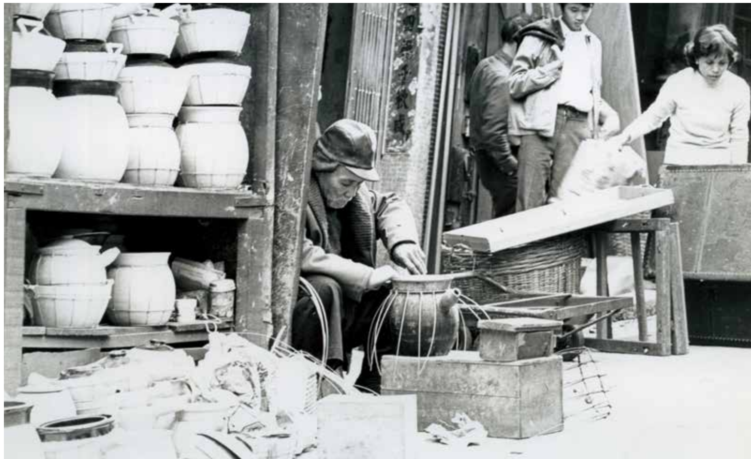
補煲師傅正在用鐵線「箍煲」。圖片© 皇家亞洲學會香港。 A pot mender binding a pot with metal wires. Photo © Royal Asiatic Society Hong Kong.
