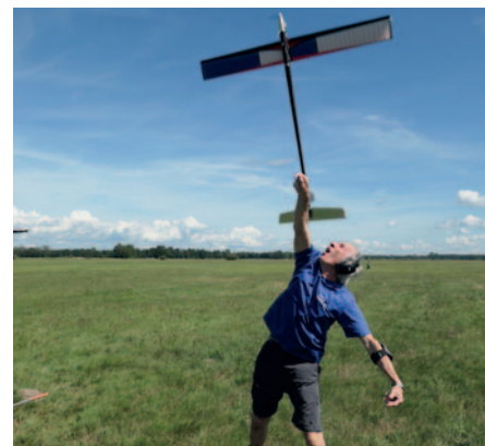
Dittmar Meissnest startet sein Verbrennungsmotormodell F1C mit seinem "Flapper" – das Modell klappt erst nach vier Sekunden Motorlauf die Tragfläche komplett auf.
