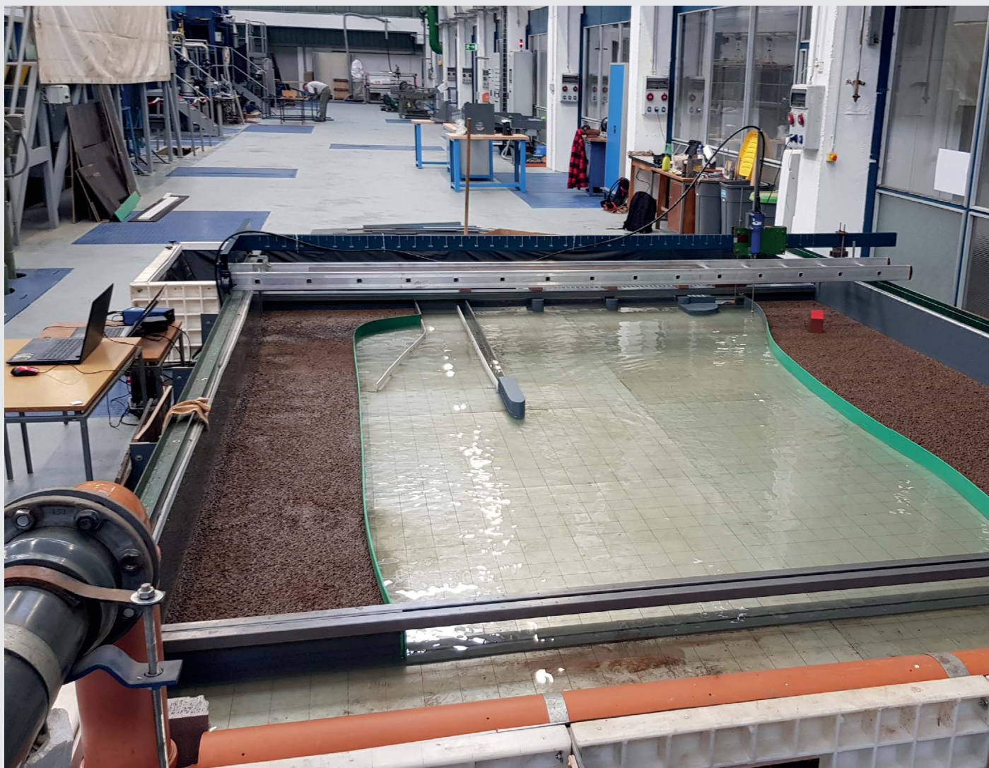
Funkční vzorek – univerzální hydraulický model zdymadel na LVVC
