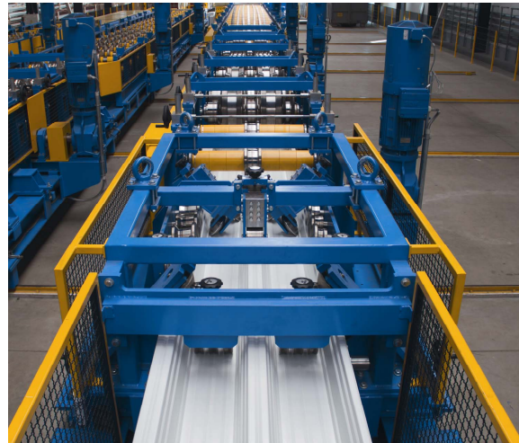
Bild 1: Profiliergang am Beispiel eines Trapezprofils
