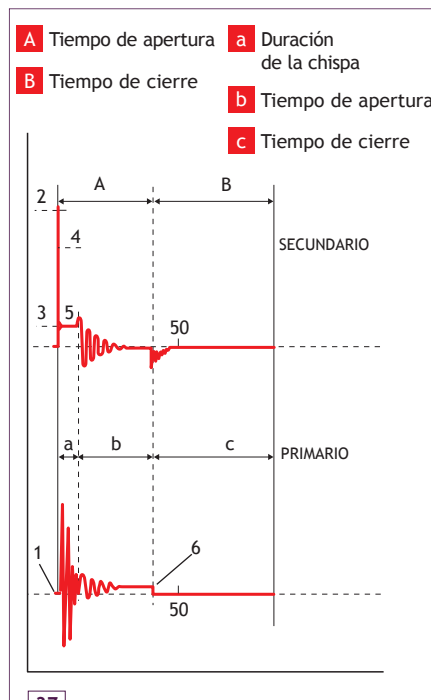
37 Oscilograma conjunto de primario y secundario.
