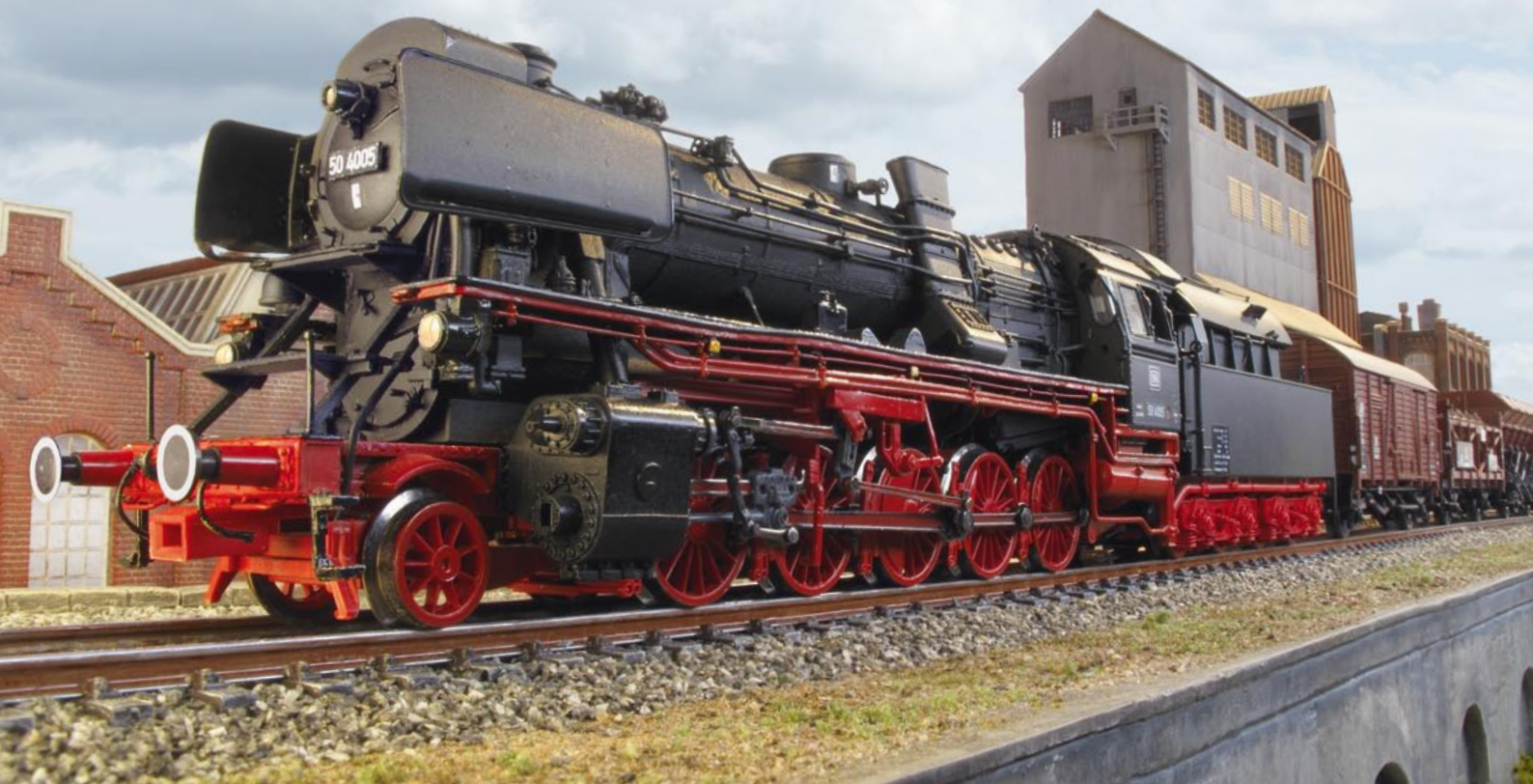
Phänomenal: Zwei Kessel, Seitenschornstein, Tender mit beweglichen Kohle-Abdeckklappen – als Trix-Clubmodell 2011 besticht die Franco-Crosti-Lok der Baureihe 50.40 mit ihrem unverwechselbaren Profil. Außerdem steht die stattliche Dampflokomotive der Epoche III für technische Raffinesse.
