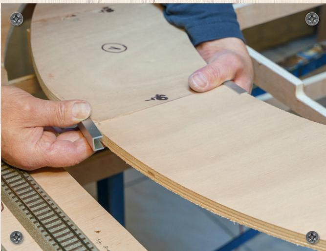
**Einfache Verbindung:** Die einzelnen Segmente der Gleiswendel werden mit Aluprofilen aus dem Baumarkt verbunden.
