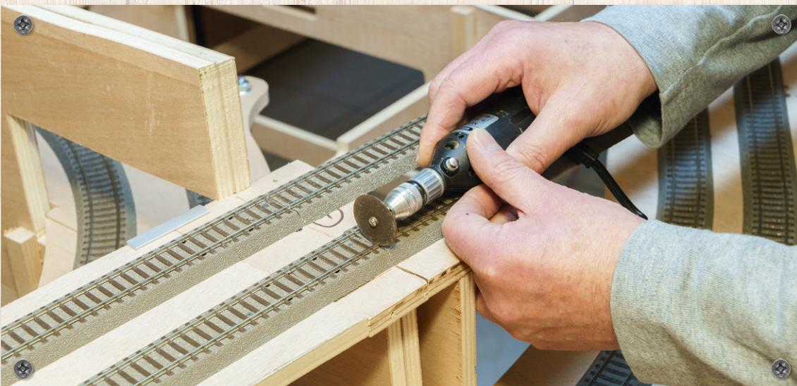
**Feinarbeit:** Mit einer Flexscheibe werden die Gleise an den Stößen der drei Anlagenmodule durchtrennt.
