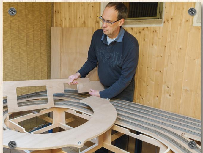
**Hoch hinaus:** Nachdem der erste Teil der Gleiswendel montiert ist, wird der ausgesägte Spant eingepasst.
