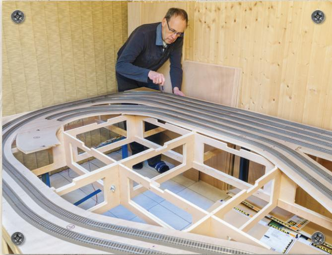
Liegeprobe: Nachdem die Trassen der untersten Ebene ausgesägt sind, werden die Gleise wieder aufgelegt.
