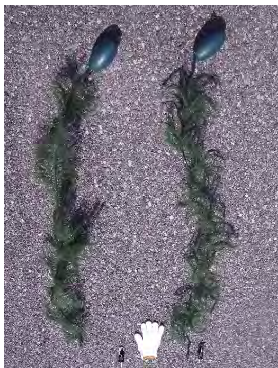
第 19 図 海域に設置した人工海藻（左：全縁型，右：隙間型）
