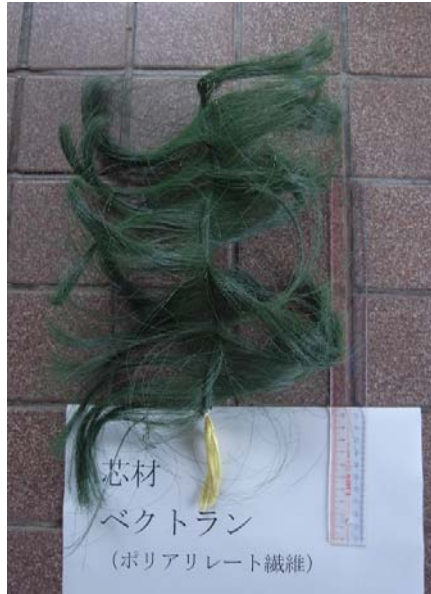
第3図 ベクトランで主軸を補強した素材（補強した主軸内は図中下部の黄色い部分）
