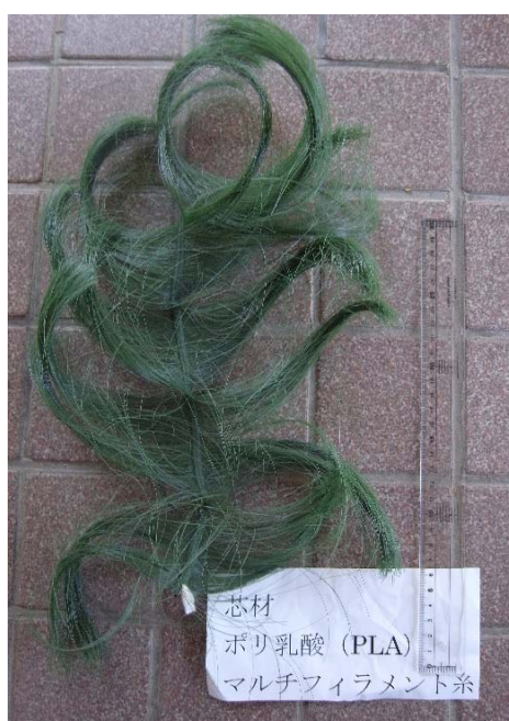
第 2 図 ポリ乳酸繊維で主軸を補強した素材（補強した主軸内は図中下部の白い部分）
